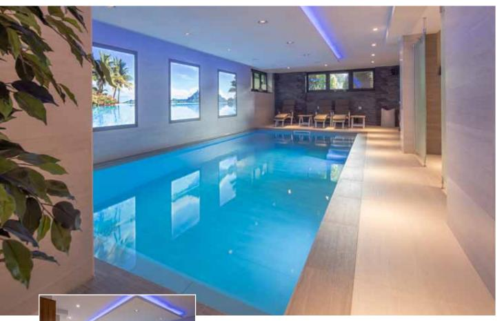
Nicht mehr wiederzuerkennen: Das Schwimmbecken wurde komplett saniert, mit einer Folie ausgekleidet und dann mit einer Rollladen-Abdeckung, Scheinwerfern und neuen Einbauteilen ausgestattet.
